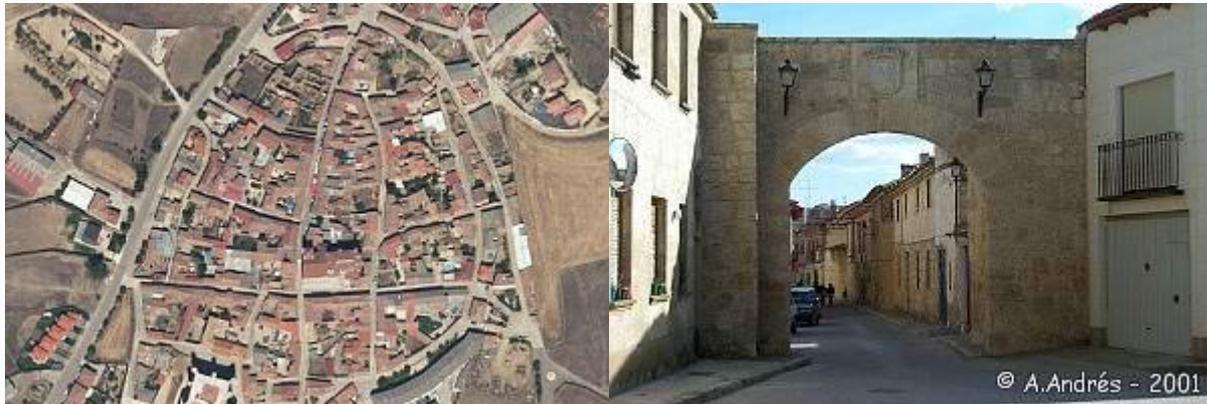
Ha sido restaurada en varias ocasiones, la última a finales del pasado siglo, cuando se realizó una consolidación de las piedras existentes, así como reposición de las que faltaban en la parte superior. Se efectuó también una limpieza del mismo, eliminación del cableado externo y colocación del escudo en el centro.
